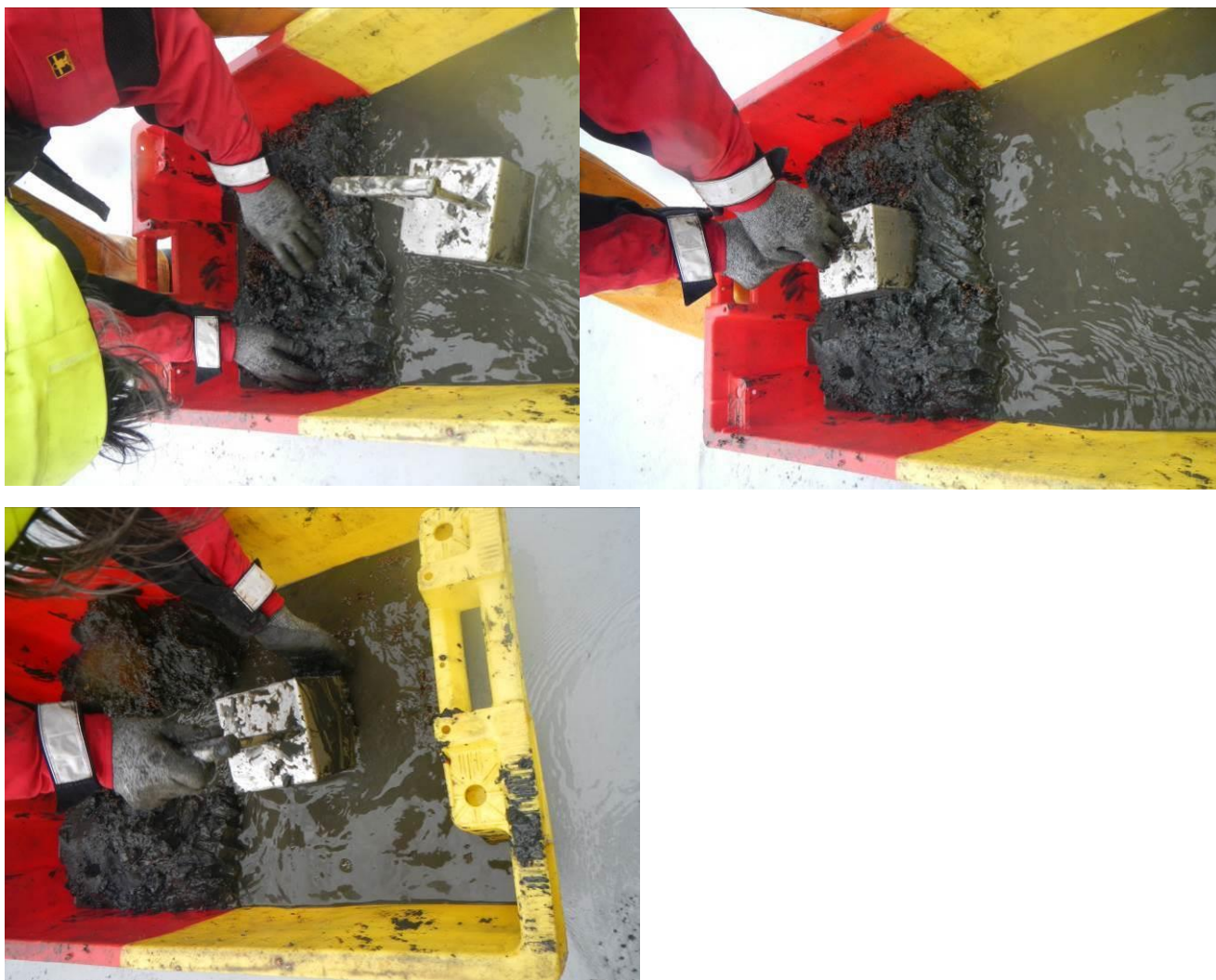
Figure 18 : Prélèvement d'un échantillon pour la mesure de vitalité ©TBM environnement, 2024.
