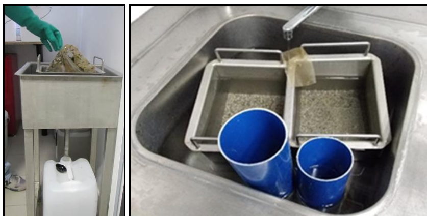
Figure 21 : Etapes du déformolage : récupération de l'eau formolée (à gauche) et rinçage (à droite) (source : TBM environnement)
