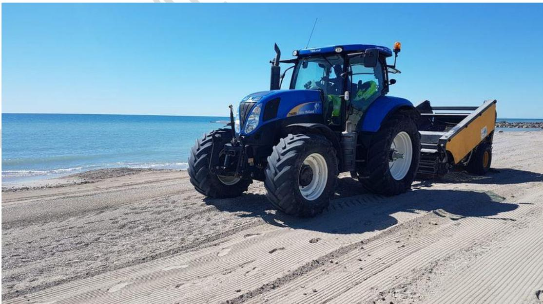
Figure 1: Cribleuse de sable sur une plage. (Eychemne, 2019)
