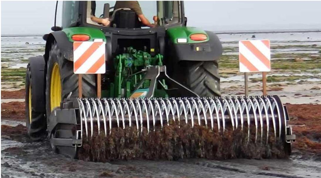
Figure 2 : Nettoyage d'une plage à l'aide d'un goémonier. (Goémonier Legiret, 2019)
